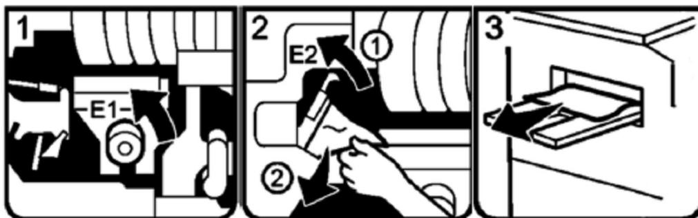
**Mở cửa trước , xoay nút E1 theo chiều mũi tên (H1) để đẩy giấy kẹt ra , đẩy tấm E2 lên (H2) (1) và rút giấy kẹt (2) . Hoặc giấy kẹt bị đẩy ra khay giấy (H3) . Đóng cửa trước lại .**
