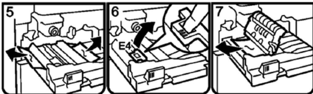
Nếu đang copy 1 mặt Face Down (bản sao ra úp) hoặc đang copy 2 mặt  Nắm chốt E1 (H4) , kéo khối Duplex ra ngoài . Rút giấy kẹt phần nạp giấy (H5) . Nắm cần E4 (H6) , bật mở phần nạp giấy của Duplex và kéo giấy kẹt ra (H7) . Đóng lại khối Duplex
